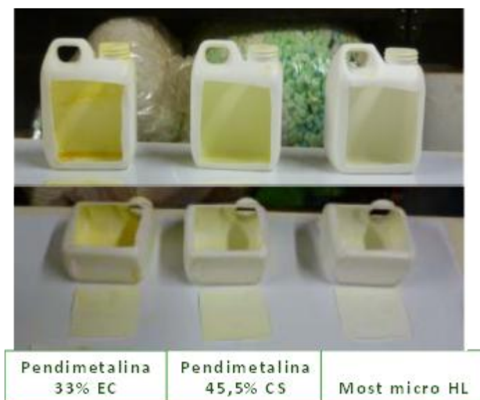
Foto 5. Aspecto de las garrafas después de contener durante 4 hrs las preparaciones y tras un triple enjuagado
